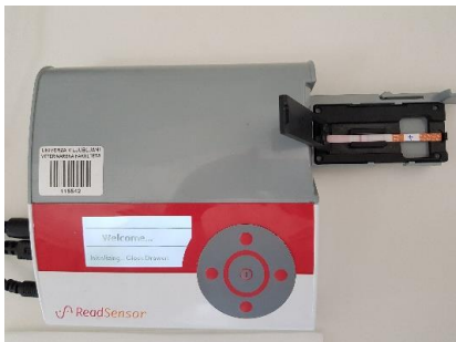
Slika 5: Spektrofotometrično merjenje intenzitete barve receptorskega testa določanja tetraciklinov
