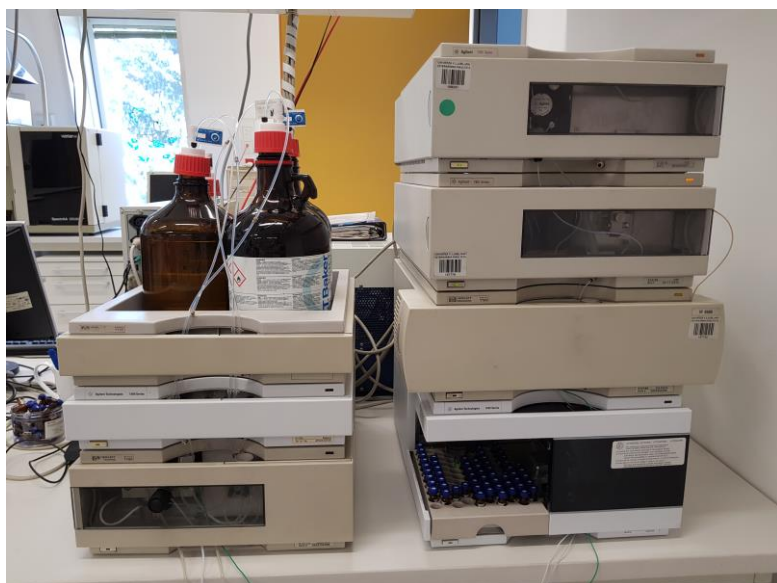
Slika 7: HPLC-FLD med analizo vzorcev medu na sulfonamide
