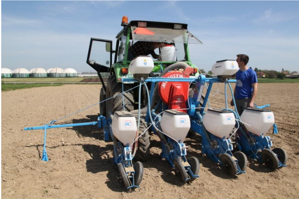
Slika 10: Prenosni sistem za aplikacijo EPN v poskusu, nameščen na koruzno sejalnico. Sistem je sestavljen iz 30l rezervoarja, črpalke in razvodnih cevi. Na večjih površinah imamo ob setvi koruze spredaj na traktorju nameščeno nošeno škropilnico, cevi za distribucijo pa napeljemo nazaj do sejalnice oz. lemežev.
