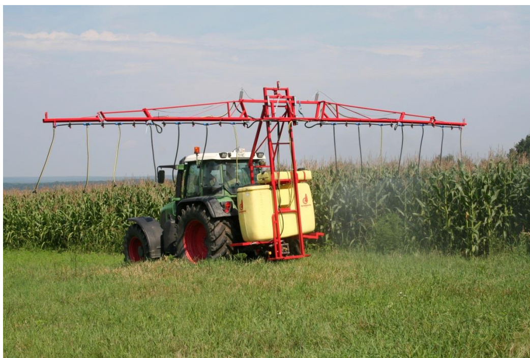
Slika 9: Škropilnica z visoko nameščenimi škropilnimi letvami in cevni podaljški do koruznega storža, ki se uporablja za zatiranje odraslih osebkov koruznega hrošča
