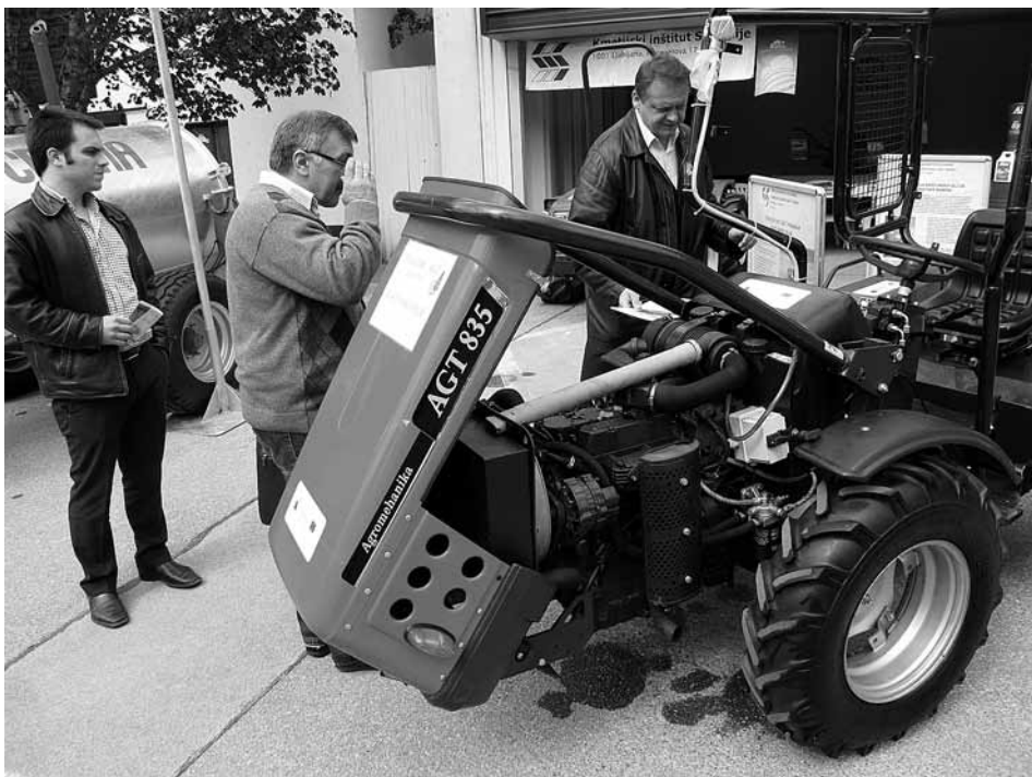
Predstavitve traktorja AGT 835 z motorjem, ki je predelan na Oddelku za tehniko tako da lahko uporablja dva goriva (mineralno dizelsko gorivo za zagon in rastlinsko olje pri opravljanju delovnih operacij) na Gorenjskem sejmu 2011, Agromehanika, Kranj
