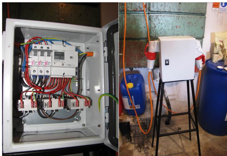
Slika 1: Prenosni merilnik porabe električne energije zasnovan na Kmetijskem inštitutu Slovenije - Oddelku za kmetijsko tehniko in energetiko, omogoča meritve porabe električne moči posameznih električnih porabnikov. Merilnik beleži trenutno, maksimalno, kumulativno itn. porabo električne energije priključenih strojev in naprav, možen pa je tudi prenos zabeleženih podatkov na računalnik.
