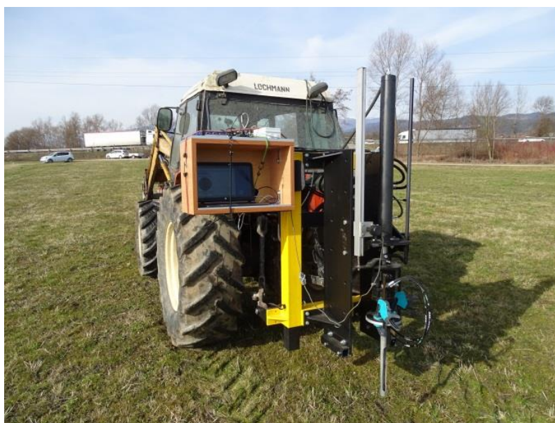
Slika 1: Mobilna naprava za ugotavljanje specifičnega upora tal in odvzem vzorcev tal razvita na Kmetijskem inštitutu Slovenije
