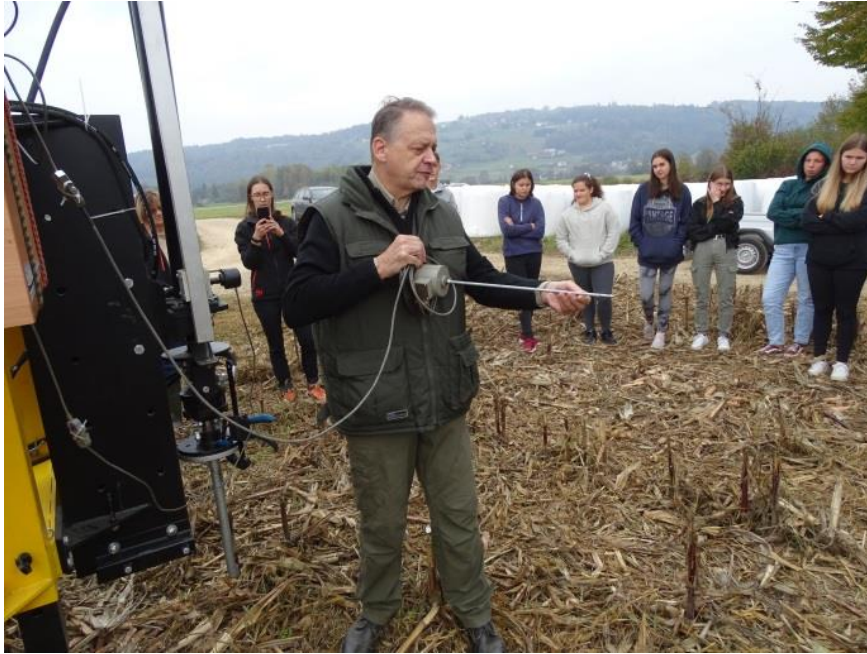
Slika 2: Predstavitev penetrometske konice s senzorjem za silo.
