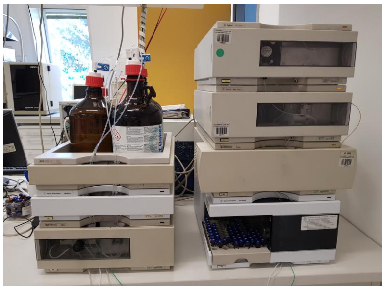
Slika 7: HPLC-FLD med analizo vzorcev medu na sulfonamide
