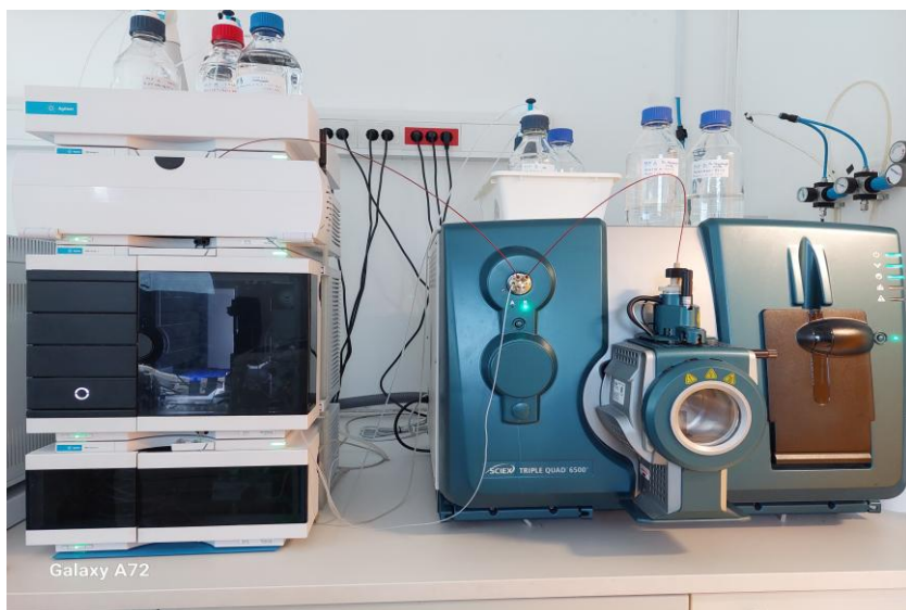
Slika 6: Tekočinsko kromatografijo s tandemsko masno spektrometrijo med meritvijo
