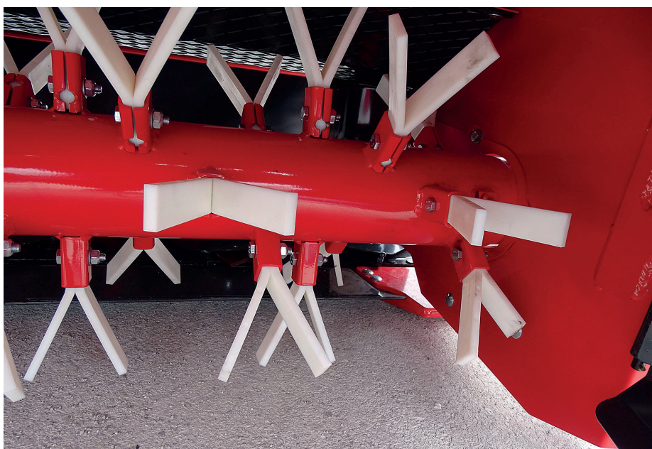
Prstni gnetilnik s plastičnimi delovnimi elementi (prsti) V oblike na SIP-ovi diskasti kosilnici. Togo so vpeti, z uporabo se počasi zaobljijo. Tak gnetilnik je lažji od prstnih gnetilnikov z jeklenimi delovnimi elementi.
