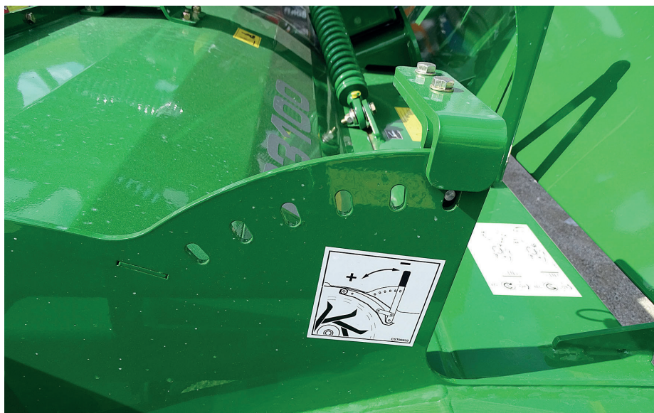
Sistem za nastavitev intenzivnosti gnetenja na kosilnici Mc Halle RC 3100 Proglide.
