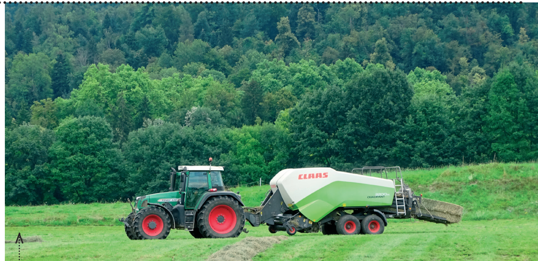
Rajko Košenina, ki opravlja storitve s kmetijsko mehanizacijo, ima na stiskalnici za kvadraste bale CLAAS Quadrant 3200 RC prigrajeno tudi napravo za nanašanje tekočih dodatkov za konzerviranje manj suhega sena. Za sedaj to preizkuša na svoji kmetiji.
