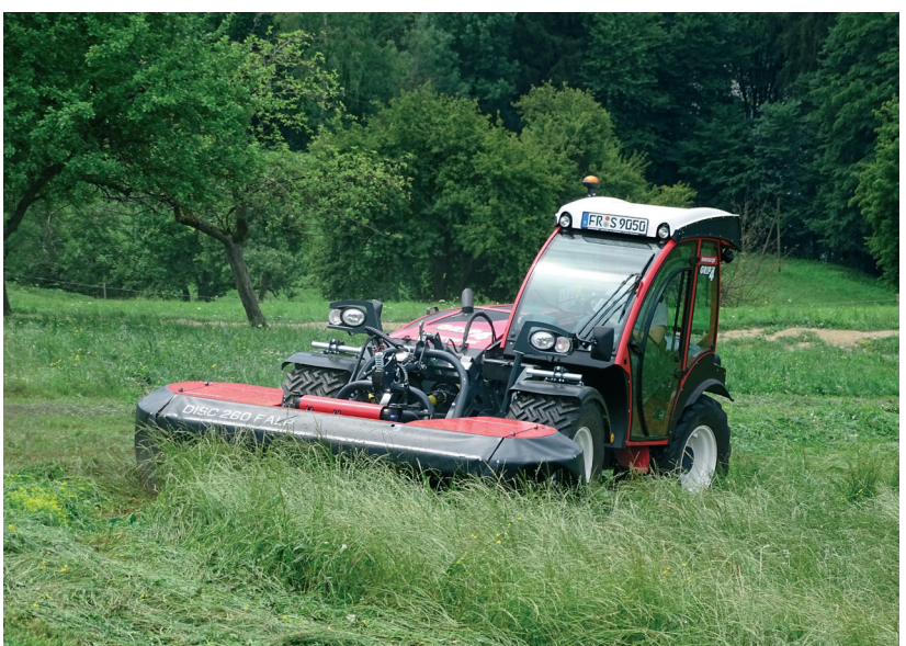
Za varno košnjo na nagnjenih terenih moramo uporabljati gorske traktorje, kot je SAUERBURGER GRIP 4, s širokimi pnevmatikami tera specialnega profila za travinje, in lažje kosilnice, kot je SIP DISC 260 F ALP.
