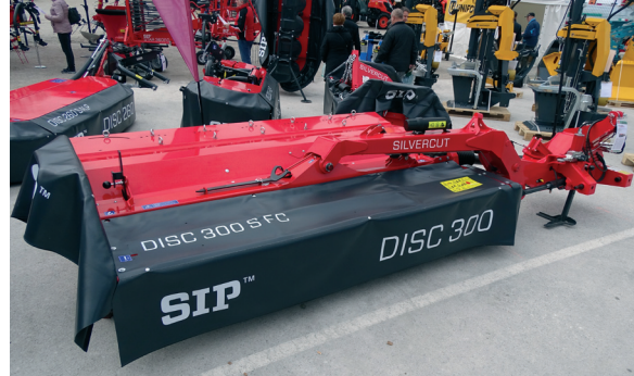
SIP je pomemben evropski proizvajalec strojev za spravilo krme. Zadnja bočna kosilnica SIP DISC 300 S FC ima prigraden prstni gnetilnik, kar pospeši sušenje krme.
