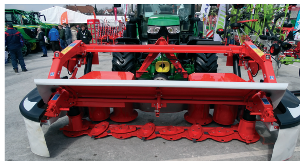
Čelna diskasta kosilnica Kuhn GMD 310 F je težka 1060 kg in ima 3,11 m delovne širine
