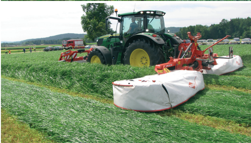
Združevanje kosilnic je ena izmed možnosti za povečanje storilnosti. Tudi pri nas že vidimo trojčke ali metuljčke, kjer imamo na traktorju čelno in zadaj dve bočni kosilnici za levo in desno stran.
