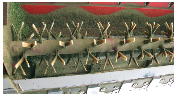
Prstni gnetilnik s plastičnimi V-delovnimi elementi na SIP-ovi kosilnici. Taki gnetilniki so namenjeni predvsem za gnetenje krme, kjer prevladujejo trava. Če so prsti jekleni, gnetilnik deluje agresivneje.
