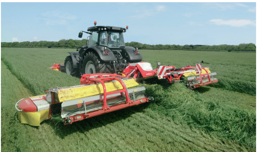
Tudi Pöttinger ima v proizvodnem programu kosilnice s transporterji pokošene krme. Med te kosilnice sodi njihova NOVA-CAT A10 ED COLLECTOR. (foto: Pöttinger)
