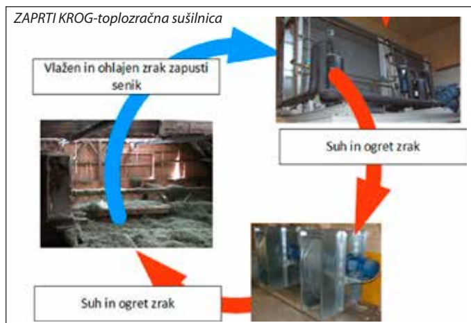
Slika 5: Zaprti krog sušenja – kondenzacijska sušilnica.
