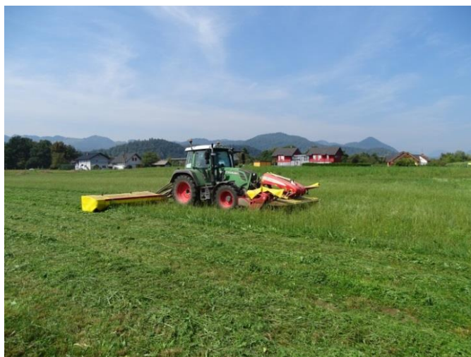
Slika 16. Merjenje porabe energije pri košnji z diskastima kosilnicama.
