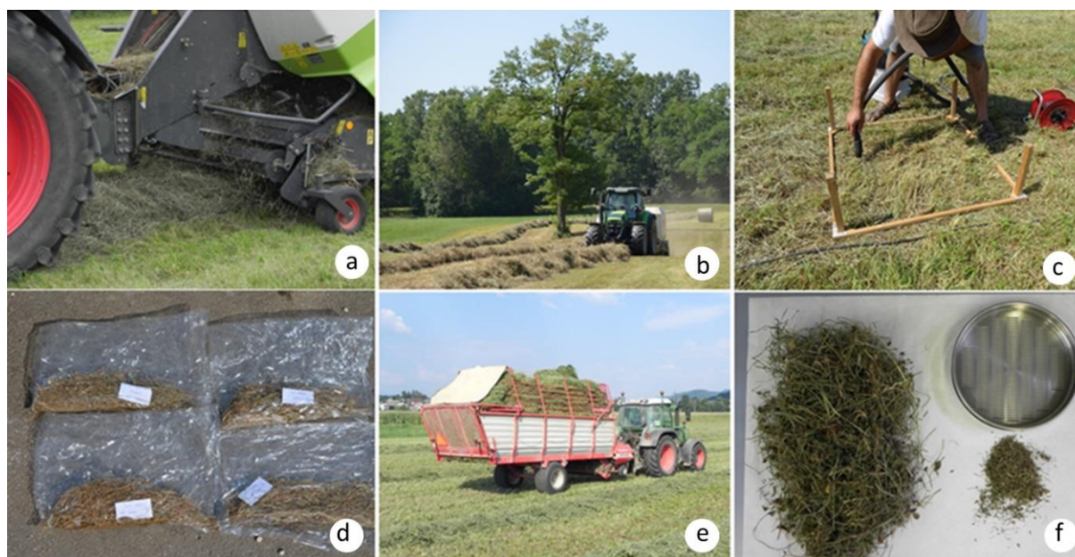
Slika 17: Izgube zaradi drobljenja pri spravilu suhe krme s balirko za velike kvadratne bale (Claas Quadrant 3200RC) (Slika a). Spravilo sena s balirko za valjaste bale (Claas Rollant 255) (Slika b). Zbiranje zdrobljenega rastlinskega materiala s t.i. metodo sesalca (Slika c). Zbrani vzorci izgubljenega rastlinskega materiala (slika d). Spravilo lucerne s nakladalko (Pöttinger Laderprofi II) na sušilno napravo ki zajema zrak izpod strehe (Slika e). Ločevanje rastlinskih delcev in anorganskih primesi v zbranih vzorcih (Slika f).
