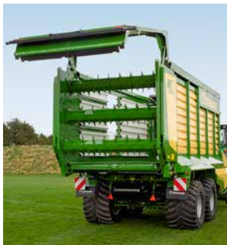
Razmetovalna naprava s tremi valji za razkladanje tovora. (vir slike: Krone)
