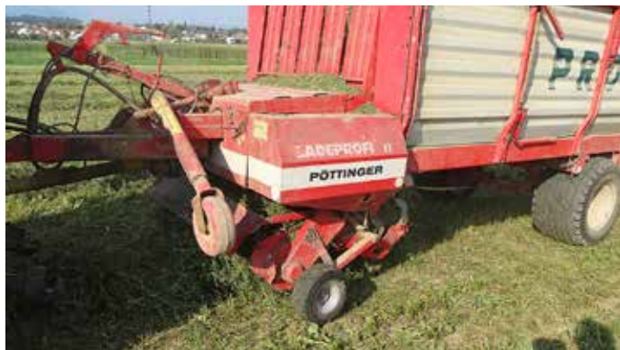
Ob pobiranju suhe krme s samonakladalno prikolico je za kakovostno spravilo odločilno dobro delovanje pobiralne naprave.
