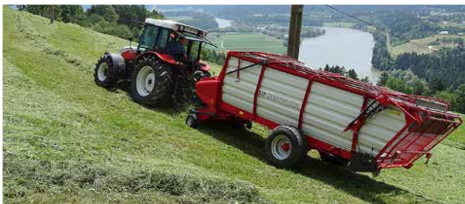
Nizkopodne izvedbe samonakladalnih prikolic s širokim kolotekom in tovorno ploščadjo med kolesi so primerne za delo na nagibu.
