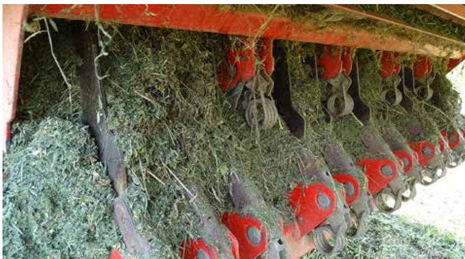
Ob pobiranju suhe krme s samonakladalno prikolico nastajajo izgube krme zaradi drobljenja. Del teh izgub se nalaga tudi na zadnjem delu pobiralne naprave.
