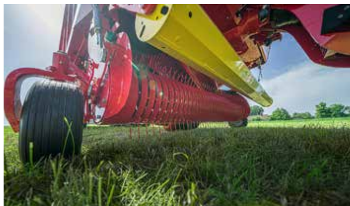
Pobiralna naprava pri Pöttinger Jumbo samonakladalni prikolici (vir slike: Pöttinger)
