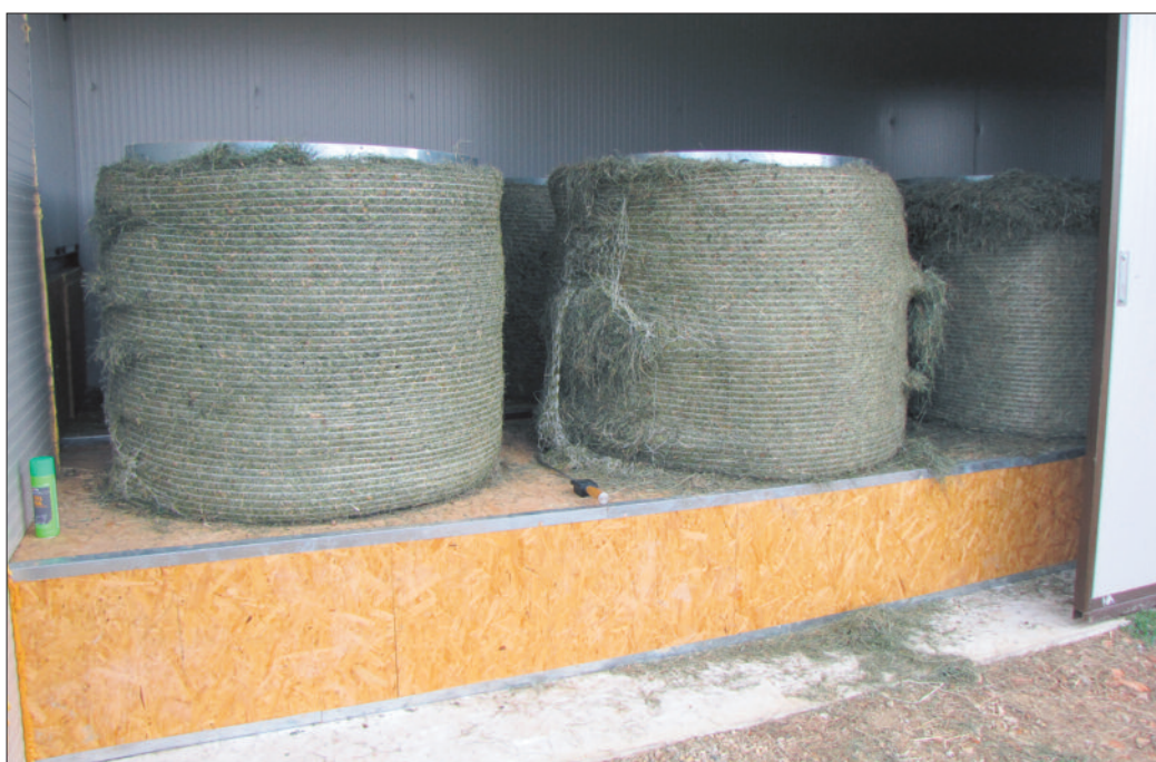
V sodobnih sušilnih napravah lahko sušimo (dosušimo) tudi krmo v valjastih balah. Na fotografiji je kondenzacijski tip sušilnice.
