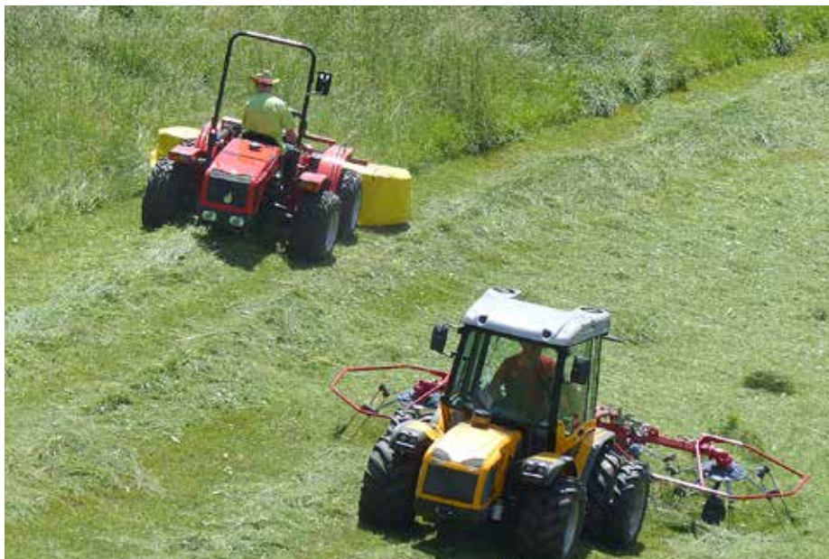
Levi traktor je gorska izvedba traktorja Agromehanika AGT 850 s kosilnico za košnjo nagnjenih terenov. Dejansko gre za razširjeno verzijo njihove kompaktne serije. Gorski traktor mora imeti ustrezno široke gume. Na tem traktorju so Alliance pnevmatike široke skoraj 400 mm, imajo pa profil reber, ki zelo dobro varuje travno rušo pred poškodbami. Desno je kompaktni traktor Pasquali Orion, ki ima pnevmatike široke 425 mm. Kljub temu, da imajo te pnevmatike standardna rebra, so zaradi svoje velike širine prijazne do tal (in travne ruše), povečajo pa tudi bočno stabilnost tega kompaktnega traktorja. Z namenom še večje stabilnosti traktorja je zadnja os opremljena z dvojnimi pnevmatikami (foto Tone Zupančič).
