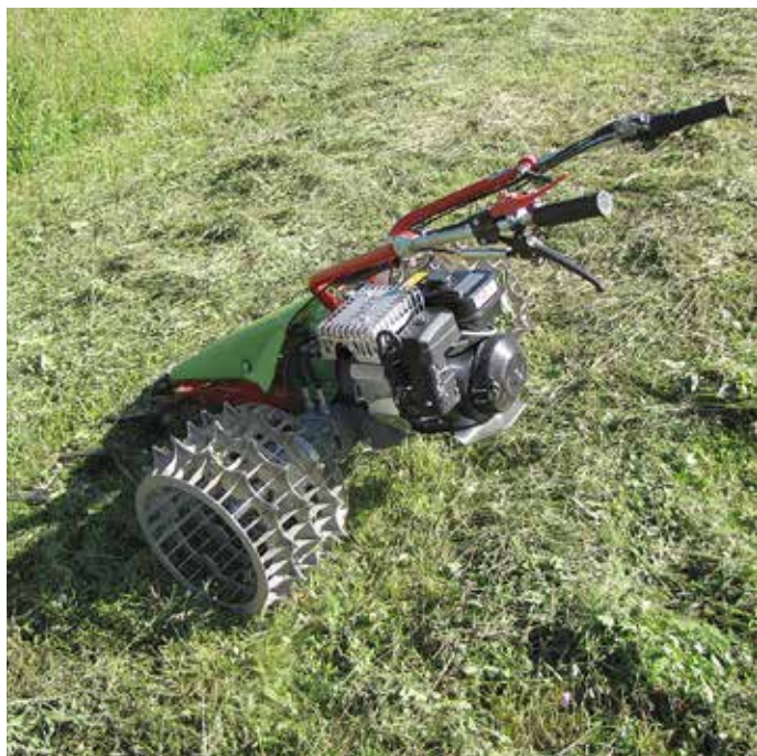
Rapid REX je ročno vodena motorna strižna kosilnica, ki je primerna za košnjo strmin. Ima lahko različno široka kovinska – aluminijaska kolesa, ki skupaj z nizkim težiščem zagotavljajo varno delo na ekstremnih nagibih.
