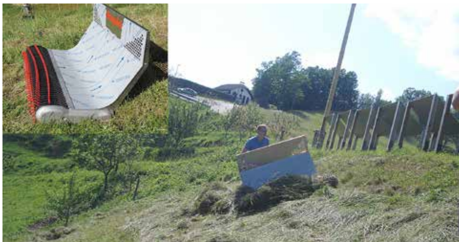
Priključek za grabljenje sena, ki se pripne na enoosni traktor (ročno vodene motorne kosilnice, ko jim snamemo kosilnico). Ta priključek (v našem primeru Rapid TWISTER) omogoča grabljenje ali transport sena tudi tam, kjer so zaradi nagiba to prej ljudje delali ročno.
