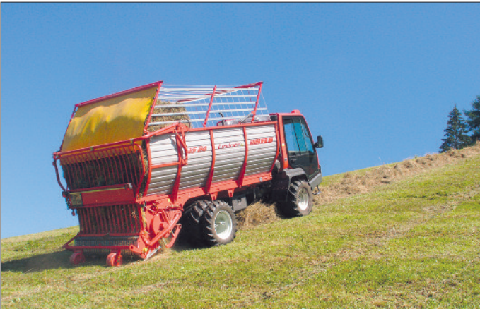
Traktor transporter Lindner Unitrac ima prigrajeno nakladalno prikolico, s katero pobira travo (seno) na zadnjem koncu traktorja. Na transporterju imamo lahko različne priključke. Zaradi nizkega težišča lahko traktorji transporterji varno delajo do nagiba 50 odstotkov. Nekatere izvedbe se uporablja do nagiba 60 odstotkov.
