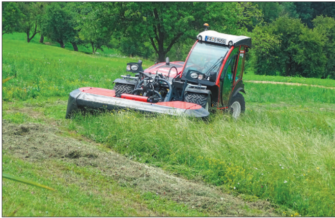
Med gorske traktorje spada nemški Sauerburger Grip 4, ki ima 70 kW (95 KM) in dvostopenjsko hidrostatskično transmisijo. Okretnost mu povečujejo štirje načini upravljanja koles. Management motorja in transmisije omogoča štiri vozne moduse. Ima široke terra pnevmatike specialnega profila za travinje, kar zagotavlja varovanje travne ruše. Spredaj ima pripeto kosilnico SIP DISC 260 F ALP, ki tehta 460 kg in je namenjena košnji na strminah.
