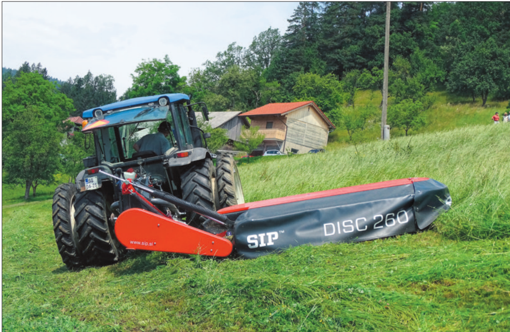
SIP-ova bočna zadaj pripeta kosilnica DISC 260 S ALP ima možnost prilagajanja terenu od +30 do -40 stopinj. Diski se vrtijo v sredino. Razbremenjevanje kosilnice omogoča DUAL SPRING sistem dveh vzmeti. Kosilnica je varovana pri naletu na oviro. Tehta 540 kg. Pripeta je na traktor New Holland T 4050, ki ima zadaj dvojna kolesa, kar mu poveča bočno stabilnost.
