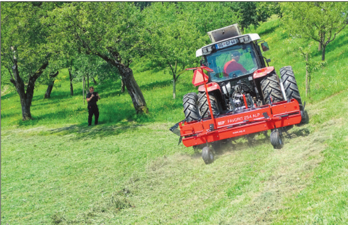
Tračni obračalniki/zgrabljalniki še vedno ostajajo v programu SIP-a. Uporabljajo se predvsem za delo na strmini in na majhnih parcelah. Model Favorit 254 ALP ima 2,5 metra delovno širino, tehta pa 295 kg. Pripet je na traktor Steyr, ki ima zadaj dvojna kolesa.
