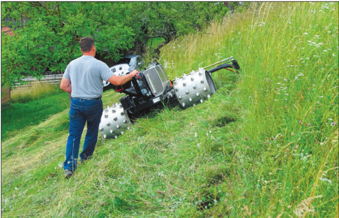
Na strminah, kjer ne moremo več uporabljati dvoosnih traktorjev, najdejo svoj prostor ročno vodene motorne kosilnice (enoosni traktorji). Nekateri proizvajalci uporabnikom dajo poleg še dereze za bolj stabilno hojo za strojem. Na sliki je avstrijski IBEX s specialnimi kovinskimi kolesi, ki imajo po obodu stožce za boljši oprijem.
