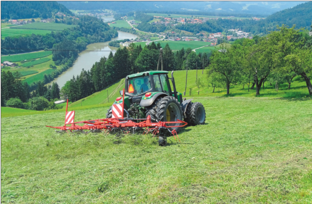
John Deere 6430 je dokaj velik traktor za delo na strmini. Zato je opremljen z dvojnimi pnevmatikami na obeh oseh, kar mu omogoča večjo stabilnost.
