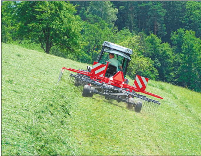
Vlečen SIP-ov vrtavkasti zgrabljajnik STAR 430/12 T lahko dela zgrabek širok od 0,7 do 1,2 metra. Pripet je na kompaktni traktor Ferrari Vega 85 RS z enako velikimi kolesi. Dvojne pnevmatike nameščene na zadnji osi in relativno nizko težišče omogočajo delo na nagibu.
