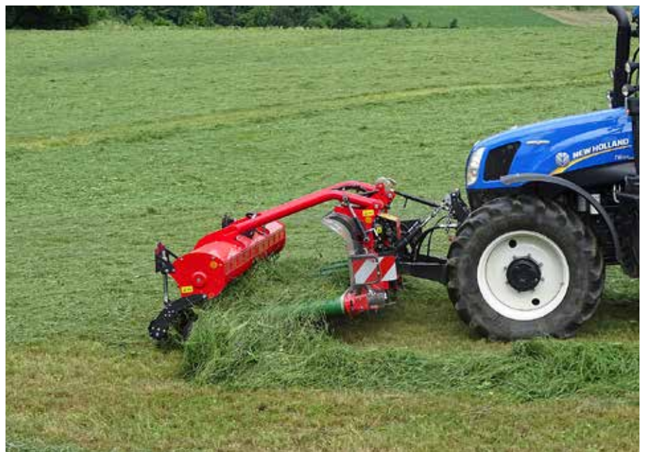
SIP-ov AIR F zgrabljalnik s pobiralno napravo in prečnim odlagalnim trakom
