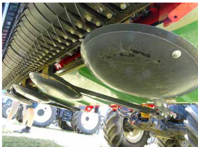
Zgrabljalnik nalega na štiri prosto vrtljive drsne krožnike (drsni), ki zagotavljajo idealno vodenje pobiralne naprave.
