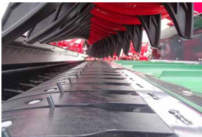
Spodaj pobiralna naprava, zgoraj usmerjevalni prstni rotor
