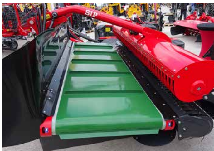
Prečni odlagalni transportni trak je lahko širok 70 ali 100 cm. Ima prečne letvice, poganja ga hidromotor, s pomočjo katerega uravnavamo tudi hitrost premikanja traka.
