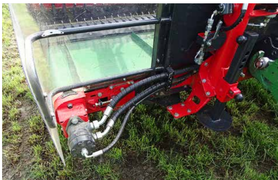
Hidromotor, ki omogoča premikanje transportnega traka.
