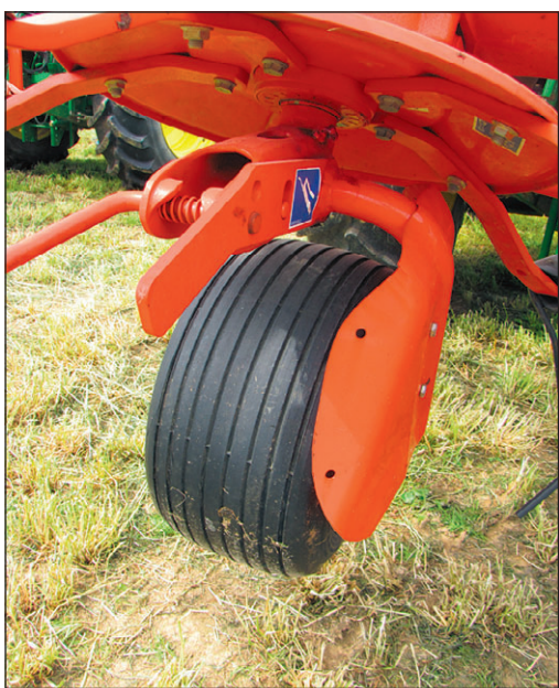
Kuhnov obračalnik in eno izmed njegovih koles, kjer se vidi zaščita pred navitjem krme in sistem za spreminjanje trosilnega kota vrtavk.
