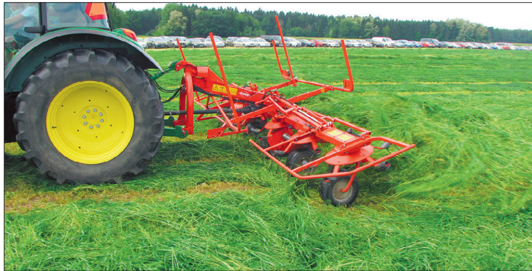
Pri razmetavanju – trošenju pokošenih redi je treba zagotoviti višje število vrtljajev priključne gredi in večji kot vrtavk.
