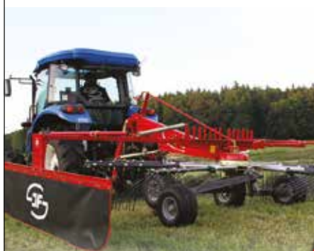
Upognjeni vzmetni prsti pri SIP-ovem zgrabljalniku STAR.
