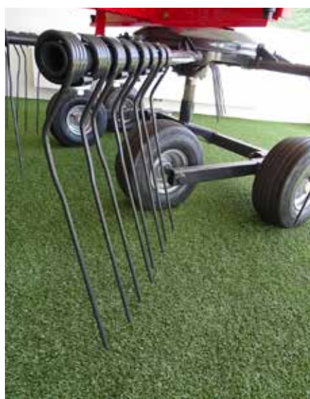
Upognjeni vzmetni prsti pri SIP-ovem zgrabljalniku STAR.
