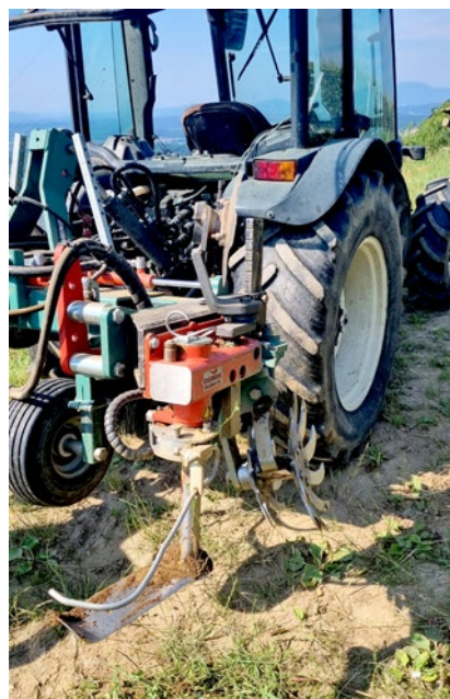
Fotografiji 9/10: Oskrba tal s spodrezovalnikom in »roll backerjem« (Foto: A. Rebernišek)
