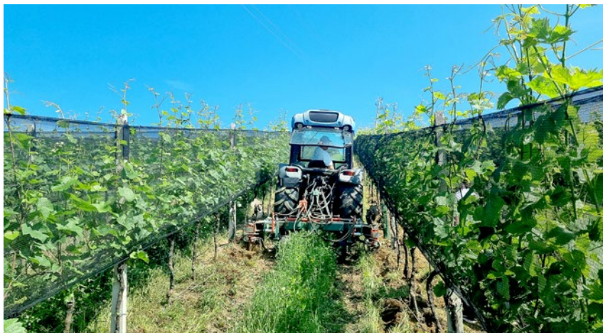
Fotografija 8: Oskrba tal s spodrezovalnikom (»lama«) (Foto: A. Rebernišek)
