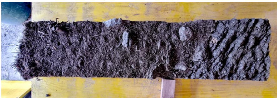
Fotografija 8: Priprava talnega monolita iz tal na Ritoznoju (Foto: T. Kralj)
