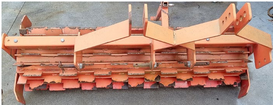
Fotografija 5: Travní valjar za oskrbo medvrstnega prostora (Foto: A. Rebernišek)
