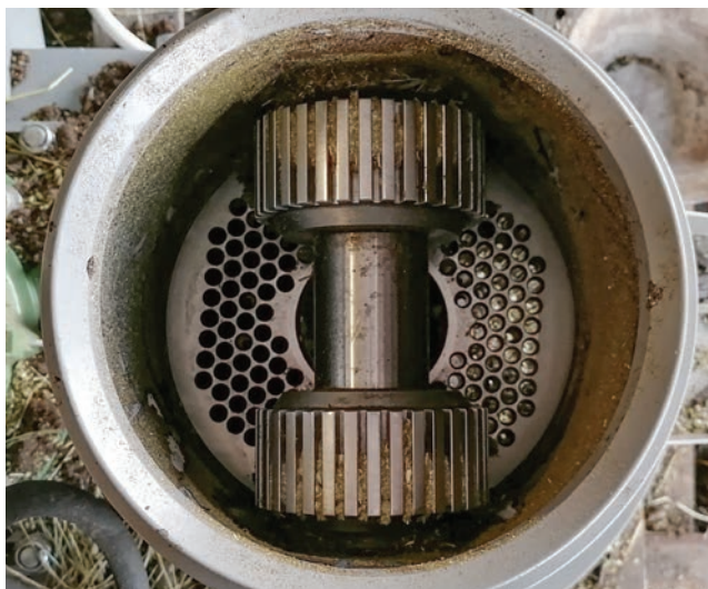
Pogled v notranjost stroja za peletiranje z dvema potisnima valjema in horizontalno izvedbo matrice za formiranje peletov
