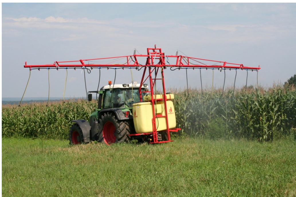
Slika 4: Škropilnica z visoko nameščenimi škropilnimi letvami in cevni podaljški do koruznega storža, ki se uporablja za zatiranje odraslih osebkov koruznega hrošča.
