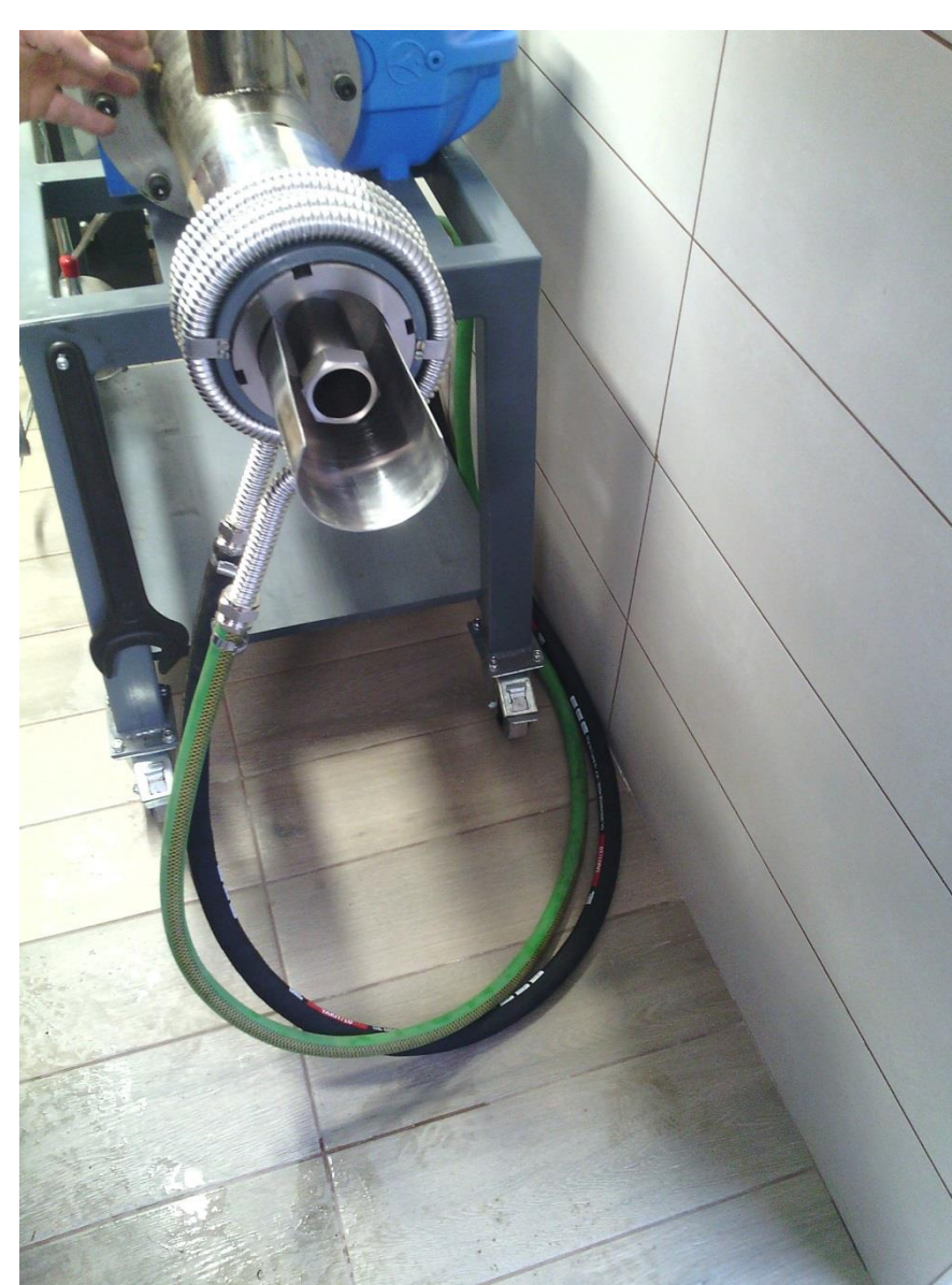
Na izstop iz stiskalnice se lahko namesti hladilni del za dodatno hlajenje pri stiskanju nekaterih oljnic in grozdnih pečk
