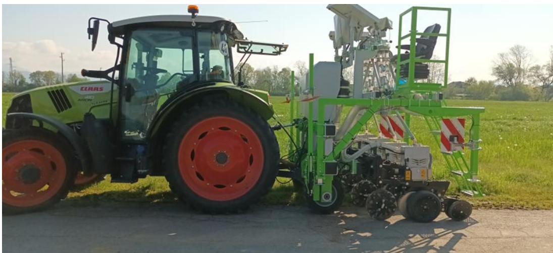
Slika 18: Presledna sejalnica znamke Wintersteiger, tip Dynamic Disc Plus R4 Planter v paketu s traktorjem Class na KIS
