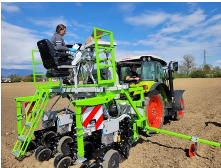
Slika 19: Presledna sejalnica znamke Wintersteiger med setvijo na KIS v Jabljah v maju 2023
