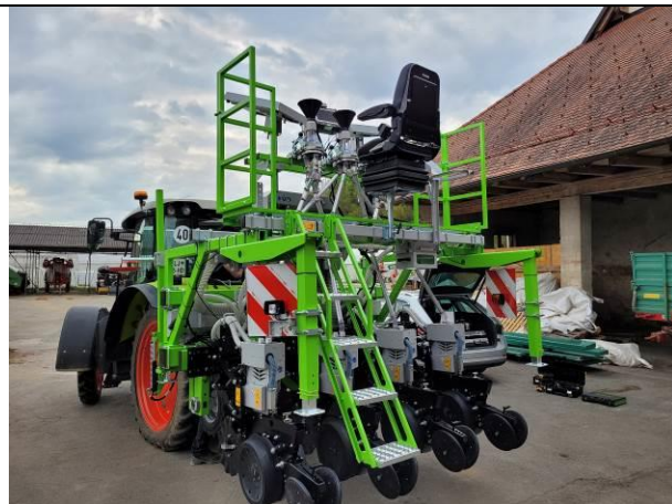
Slika 7: Sejalnica za presledno setev Wintersteiger Dynamic Disc
