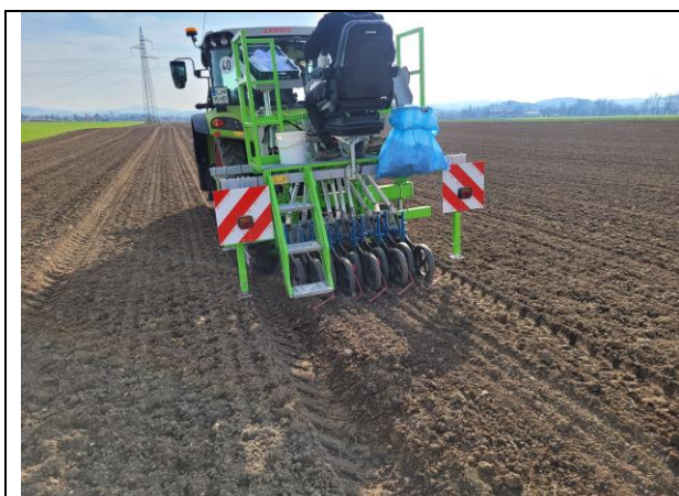
Slika 11: Setev s sejalnico za strnjeno setev Wintersteiger Plot Motion
