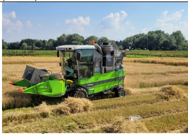
Slika 14: Žetev poskusov s parcelnim kombajnom Wintersteiger Quantum
