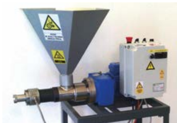
Stiskalnica AIS P 60 za mehansko ekstrakcijo oljnic z novo geometrijo stiskalnega dela AIS P 60 press for mechanical extraction of oilseeds with a new geometry of the pressing part
