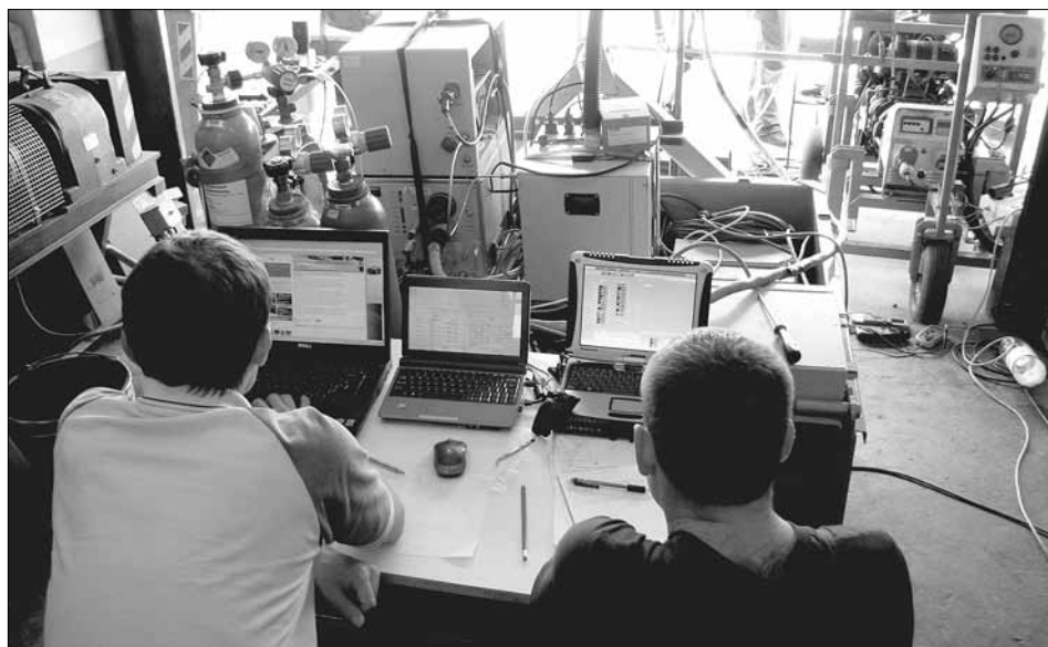
Merjenje emisij toplogrednih plinov na motorju, ki ga je poganjalo rastlinsko olje, biodizel in mineralno dizelsko gorivo
