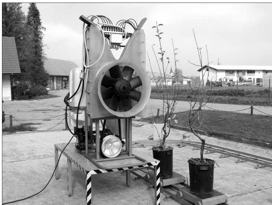
Pršilnik za ciljno nanašanje fitofarmaceutskih sredstev, zraven pršilnika je proga s transportnimi vozički, ki omogočajo premikanje drevesc ob pršilniku, na ta način simuliramo gibanje pršilnika skozi sadovnjak, raziskovalno delo pa lahko poteka tudi izven rastne sezone
