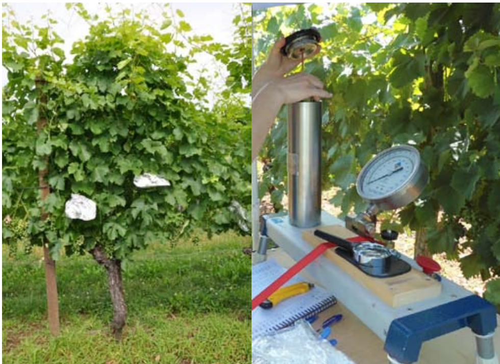
Slika 2: analize vodnega potenciala debla s Scholandrejevo komoro; aplikacija PVC-vrečk na liste vinske trte (levo), meritev vodnega potenciala (desno, slika Jež).
