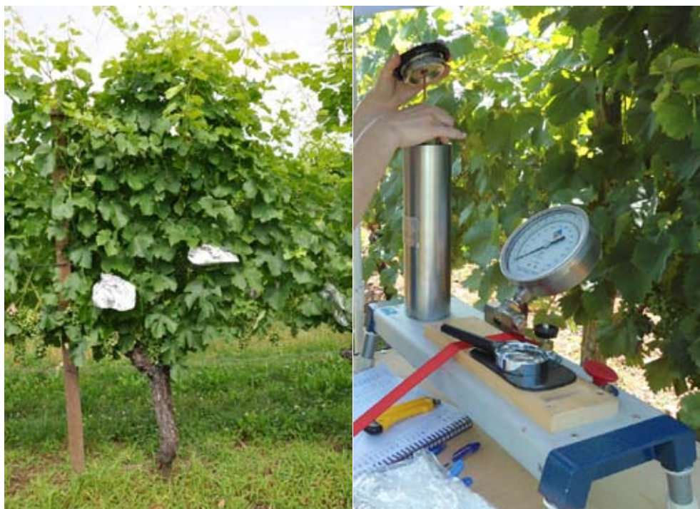
Figura 2: fasi di misura del potenziale idrico \Psi_{stem} con la camera di Scholander; applicazione dei sacchetti sulle foglie in campo (a sinistra, foto Jež), misura del potenziale idrico (a destra, foto Jež)
