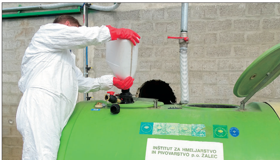
Povezava obeh adapterjev Easyflow-a je enostavna in hitra. Posoda s privitim adapterjem se le potisne v odprt adapter nameščen na škropilnici ali pršilniku.
