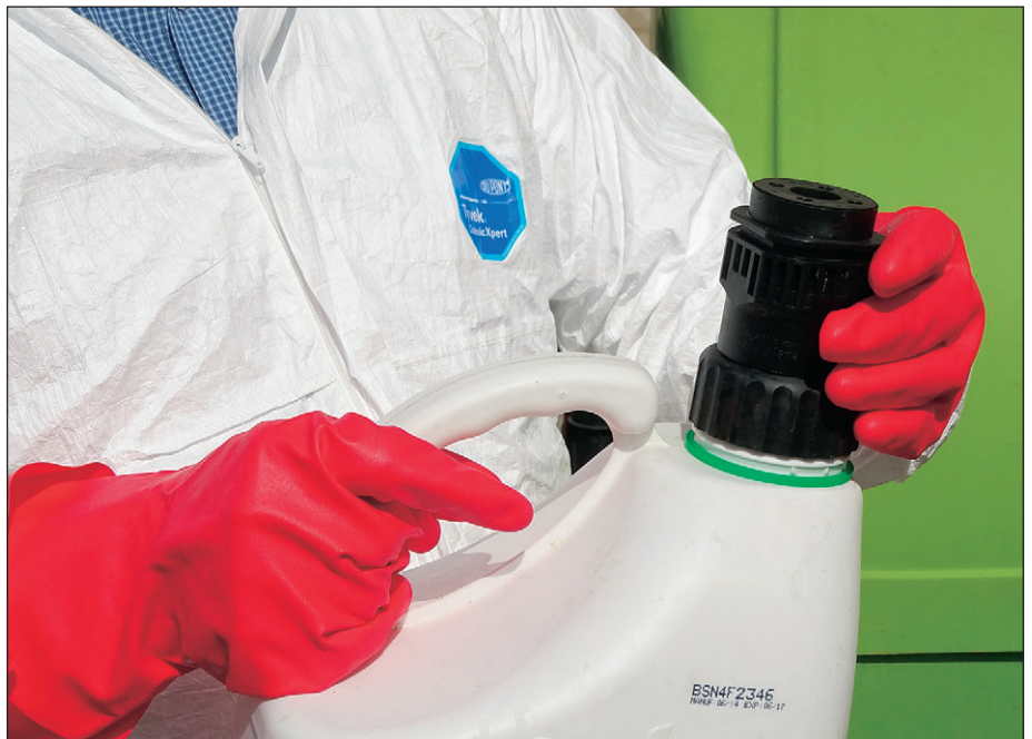
EasyFlow adapter, ki ga privijemo na posodo (kanister) s koncentriranim – nerazredčenim tekočim FFS.
