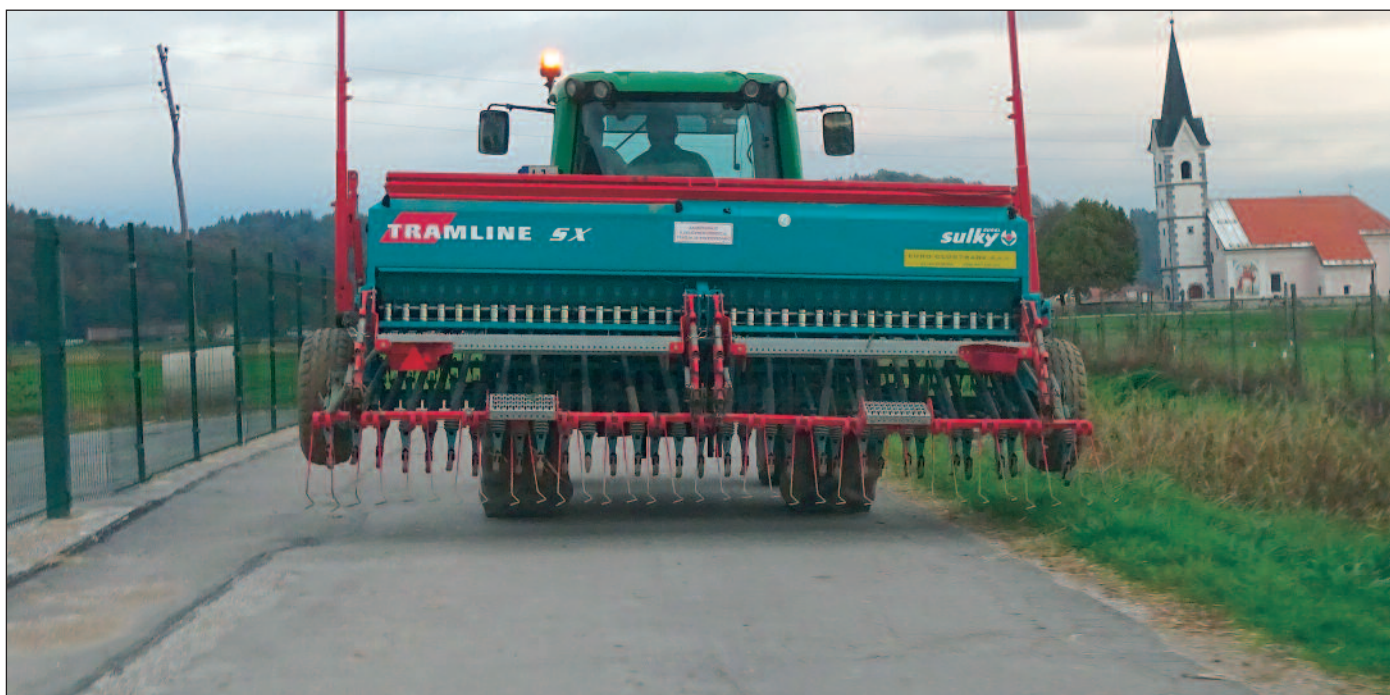
Sejalnice hitro presežejo širino za normalno vožnjo ali gospodarsko vožnjo. Širina sejalnice na fotografiji presega mejo 3,06 m za gospodarsko vožnjo, zato njen prevoz po javnih cestah zahteva izredni prevoz. Tega pa marsikdo v praksi ne izvaja.
