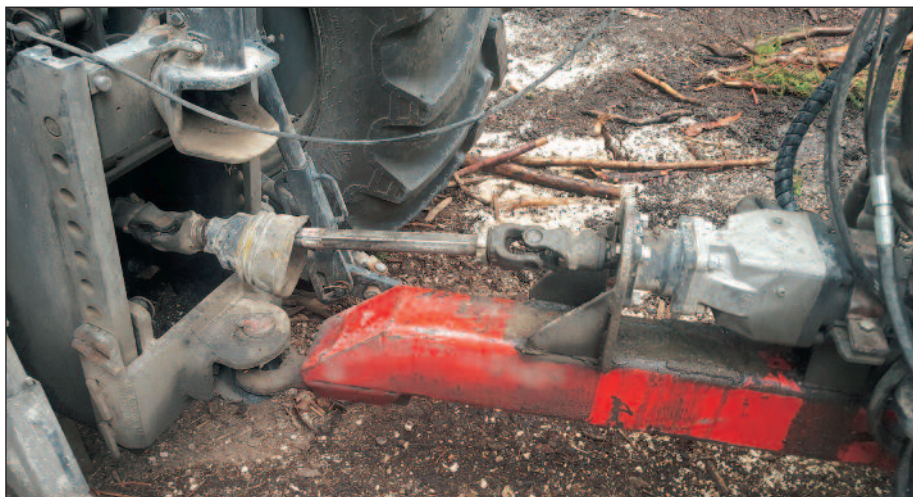
Nezaščiteni vrteči deli so velikokrat vzrok za nezgodo. Pogosto na kmetijskih in gozdarskih strojih vidimo nezavarovano kardansko gred, ki pa še vedno lahko opravlja svojo delovno funkcijo. Slikano na Gorenjskem, julija letos.
