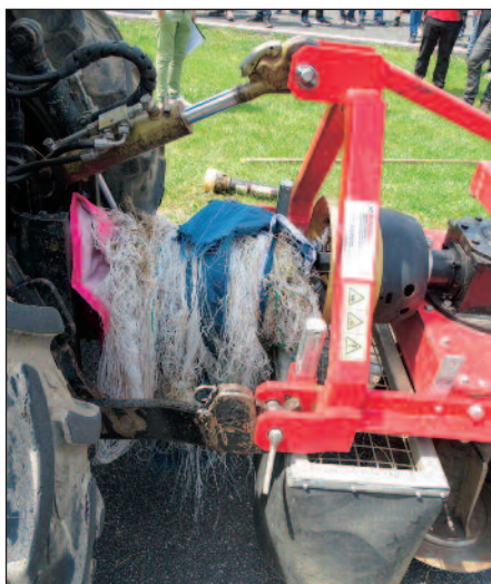
Nevarnosti pri delu gnanih priključkov s kardanskimi gredmi brez zaščite je bilo prikazano s priročno »dutko«, ki jo je vrteča kardanska gred zgrabila in navila okoli sebe. Ob takih nesrečah ljudje lahko ostanejo brez okončin ali celo brez življenja.
