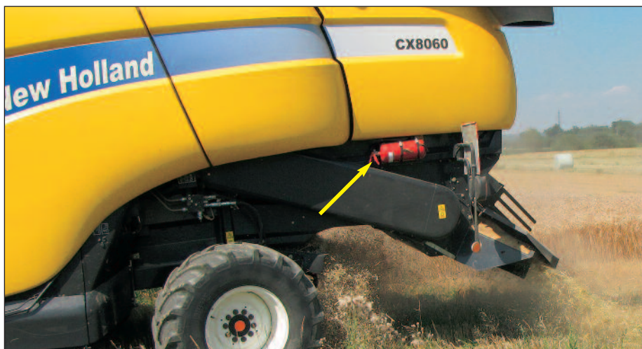
Novejši kombajni so že v osnovi opremljeni z gasilnimi aparati. Nameščeni morajo biti na lahko dosegljivih mestih, seveda morajo biti tudi ustrezno vzdrževani.
