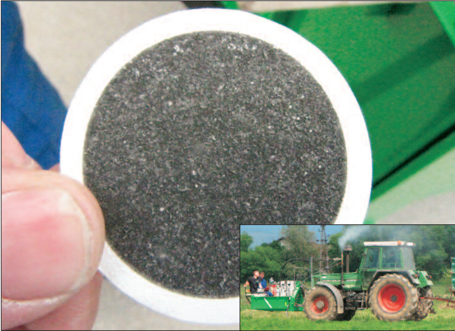
Uporaba dizelskih motorjev povzroča tudi emisije trdnih delcev. Na fotografiji so trdni delci nabrani na belem filtru ob meritvah emisij na traktorju Fendt Favorit 612 LSA na Kmetijskem inštitutu Slovenije leta 2012.
