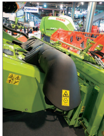
Sistem za odsesavanje prahu na dovajalnem kanalu Claas Lexiona je dodatna oprema, ki stane okrog 1.500 EUR.
