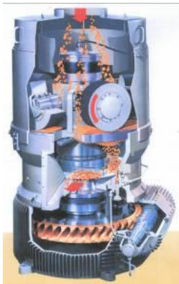
Slika 2. Stroj za izdelavo peletov z iztiskanjem lesne mase ali žetvenih rastlinskih ostankov skozi ploščato matrico (Kahl)
