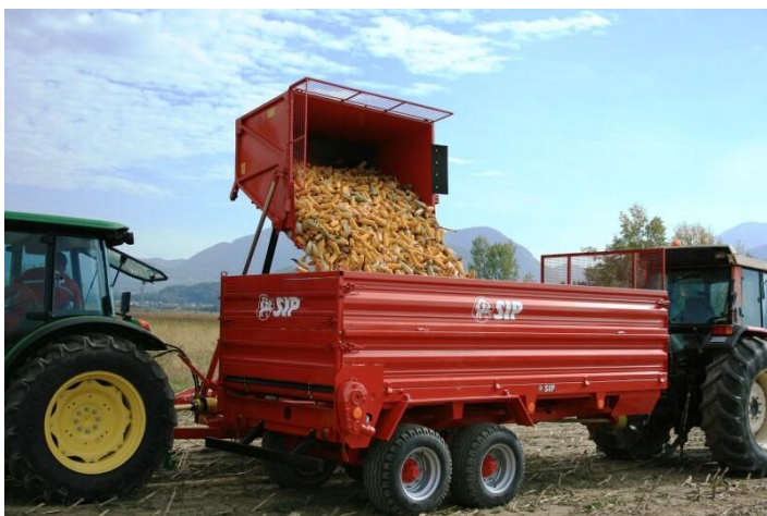
Slika 5. Praznjenje zalogovnika obiralnika koroze v storžih, transport storžev se opravlja s traktorskimi prikolicami s povišanimi stranicami, oklaski (klasinci) se lahko uporabijo za proizvodnjo energije
