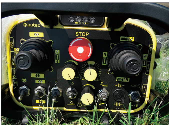
Komandna konzola za radijsko upravljanje goseničarja s priključkom.
