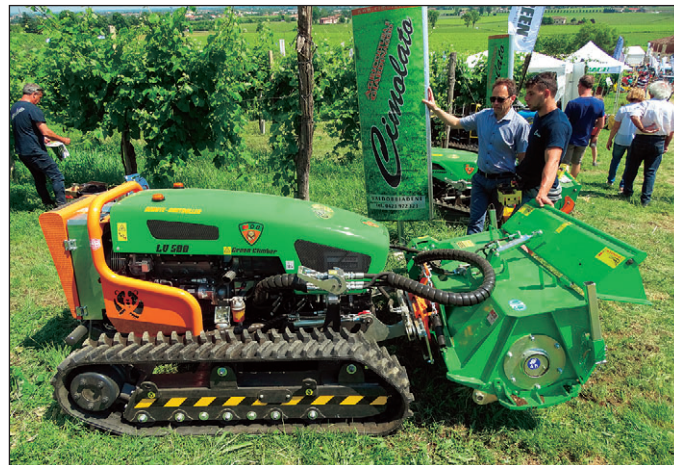
MDB GREEN CLIMBER LU 500 radijsko voden goseničar s prigradenim mulčerjem kladivarjem na hidropogon. Podvozje z gosenicami je hidravlično razširljivo iz 130 na 170 cm, kar omogoča delo tudi na 60° prečnem ali vzdolžnem nagibu.
