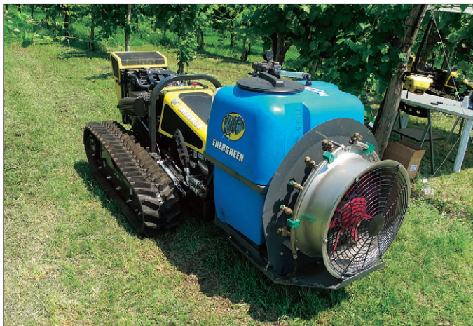
ENERGREEN ROBOGREEN s prigradenim pršilnikom obvladuje teren do 55 stopinj nagiba. Radijsko upravljanje je možno na razdalji do 150 metrov. Ima lahko različne oblike gosenic in celo vrsto priključkov.
