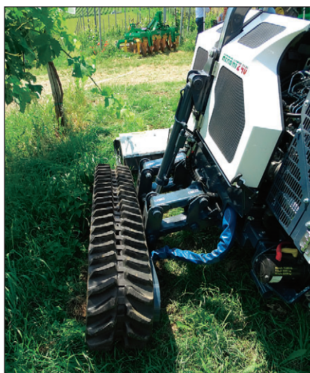
Sistem za izravnavo goseničarja na prečnem nagibu predstavlja paralelogramski okvir in hidravlični cilindar.
