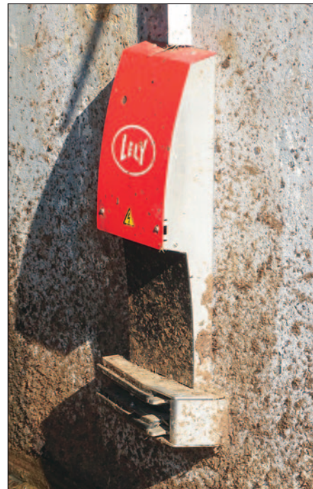
Polnilna postaja za baterijskega – električnega robota Lely. Montažo polnilne postaje mora izvesti kvalificirana oseba – električar.
