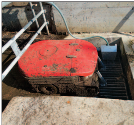
Odlagališče za robota Lely Discovery 120 Collector, ki je zavarovano le iz dveh strani (ogroja in zid). Potrebno bi bilo postaviti ograjo še na drugih dveh straneh odlagališča.
