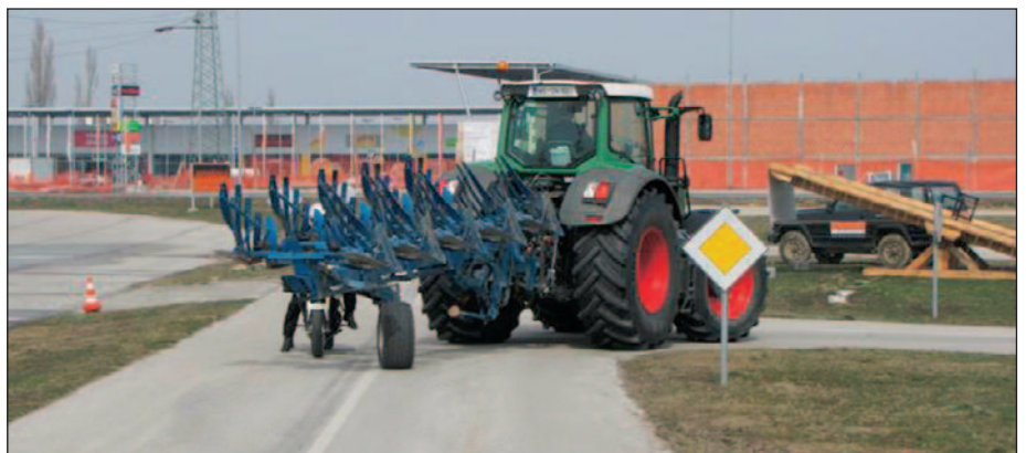
Demonstracija na poligonu: Odnašanja pluga ob zavijanju s ceste. Z nasprotne smeri pa je ravno pripeljal motorist. V resničnem primeru bi bila nezgoda lahko tragična.
