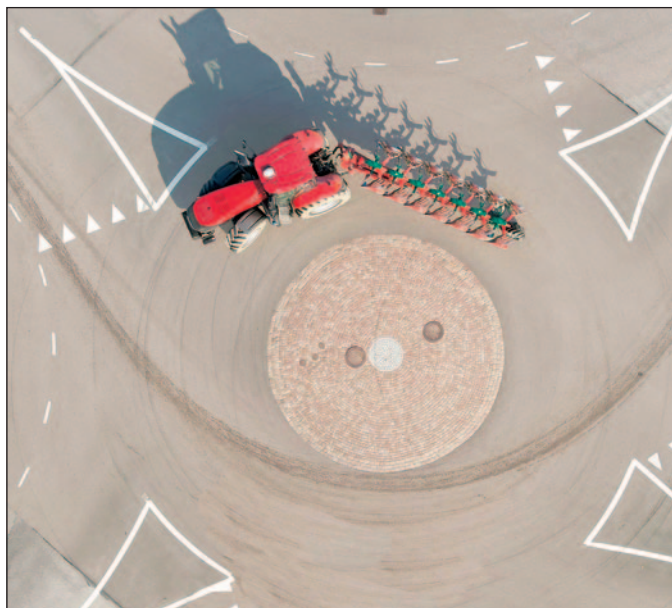
Plug Kverneland 3400 S pri uporabi TTS sistema, ki omogoča, da se sicer nošeni plug pelje za traktorjem kot prikolica. (Vir: Kverneland)
