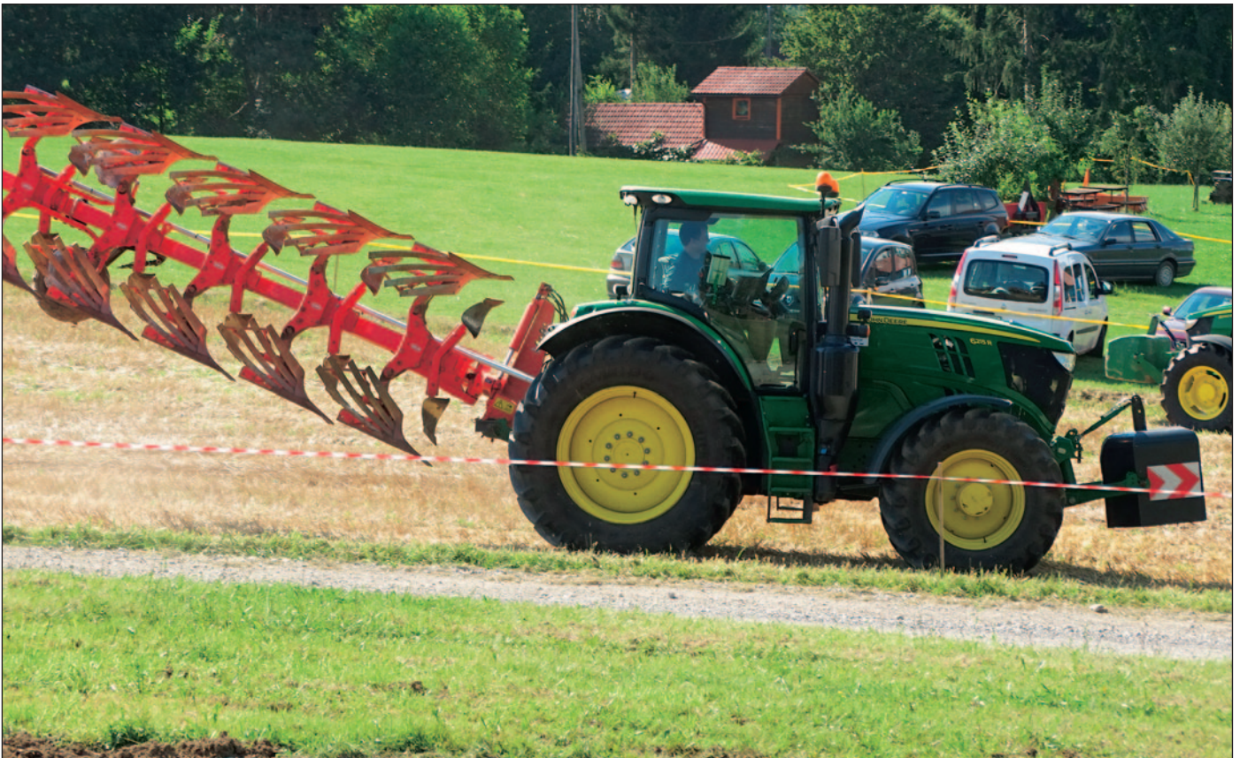
Med transportom dolgih nošenih plugov prihaja ob zavijanju do odnašanja zadnjega dela pluga, kar pomeni nevarnost za druge udeležence v prometu.
