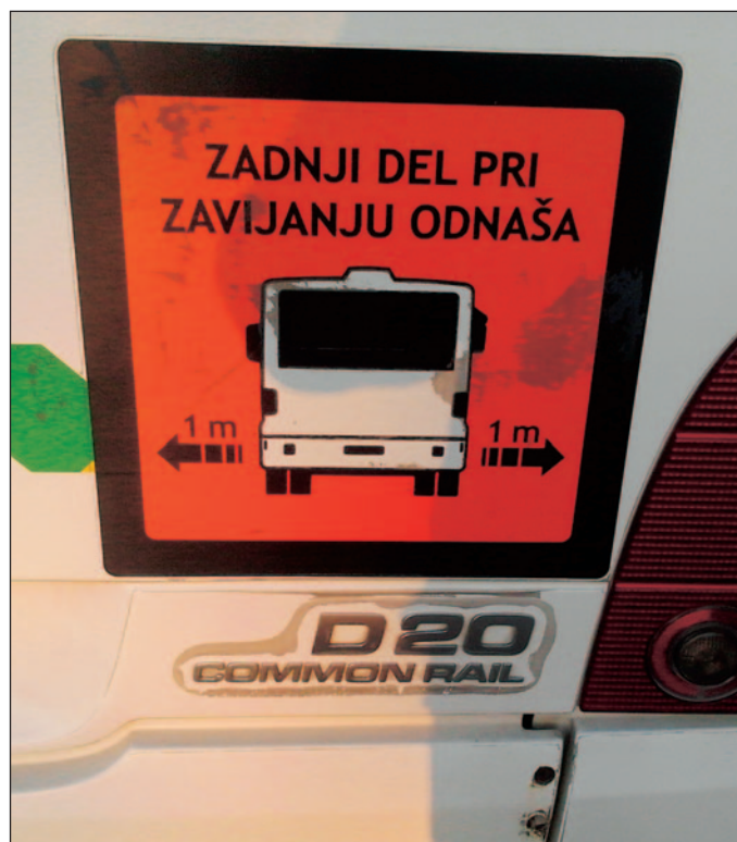
Podaljšani avtobusi imajo posebno opozorilno nalepko, da njihov zadnji konec odnaša ob zavijanju.
