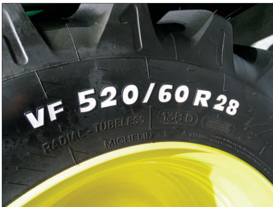
Oznaka VF pred velikostjo pnevmatike pomeni, da gre za pnevmatike, ki imajo zelo prilagodljive bočnice.
