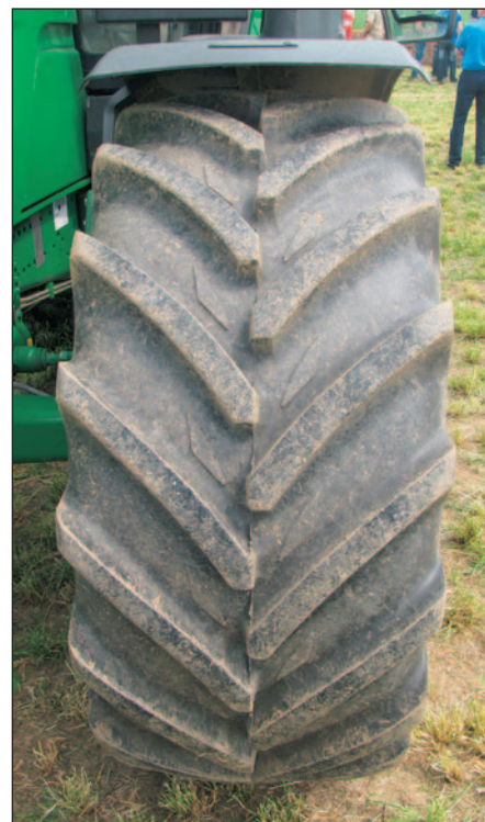
Michelin VF XeoBib pnevmatika z Ultraflex tehnologijo bočnic
