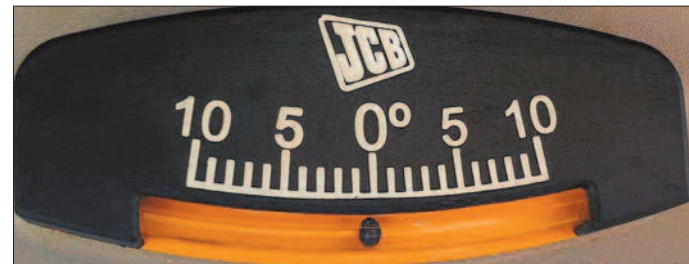
Preprost inklinometer – merilnik nagiba opozarja operaterja tudi na bočno stabilnost teleskopskega nakladalnika.
