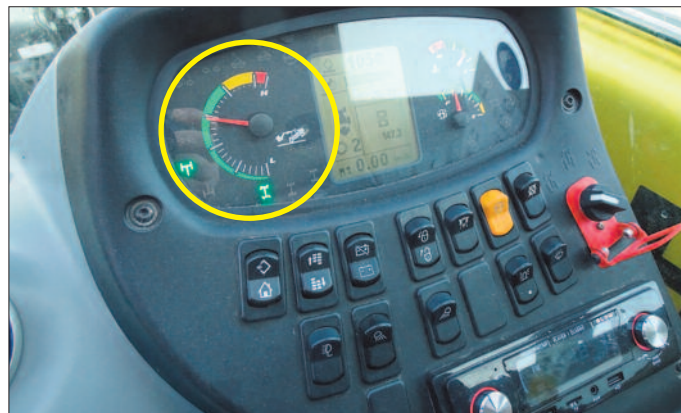
Armatura plošča teleskopskega nakladalnika New Holland TH 7.37 ima na levi strani prikazovalnik vzdolžne stabilnosti.
