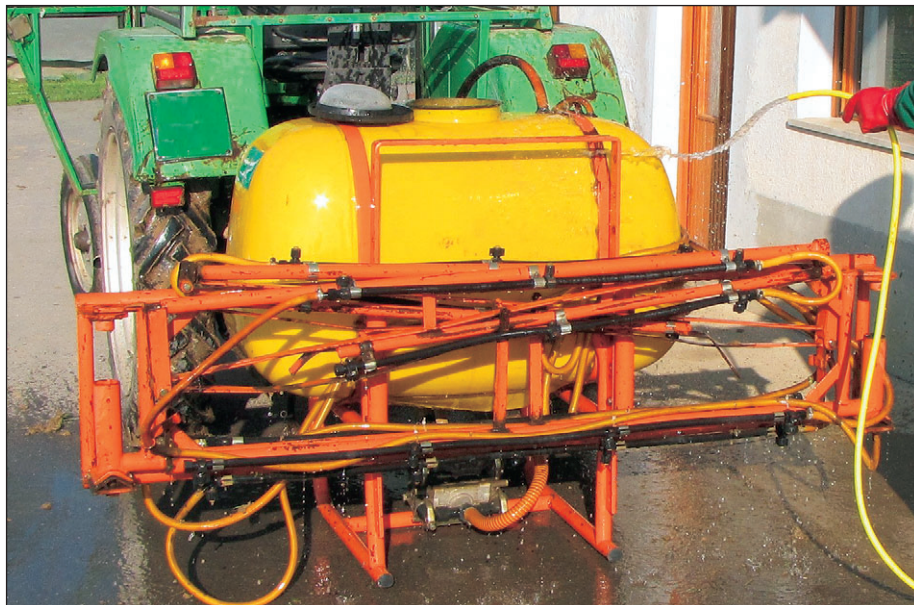
Pranje škroplilnice ali pršilnika na dvorišču kmetije se ne sme izvajati, če odpadna voda teče v kanalizacijo ali pa po površini nekam naprej. Potrebna je ustrezna betonska podlaga, kjer se odpadna voda zajame in nato ustrezno obdelata. Taki sistemi so pri nas še redki.
