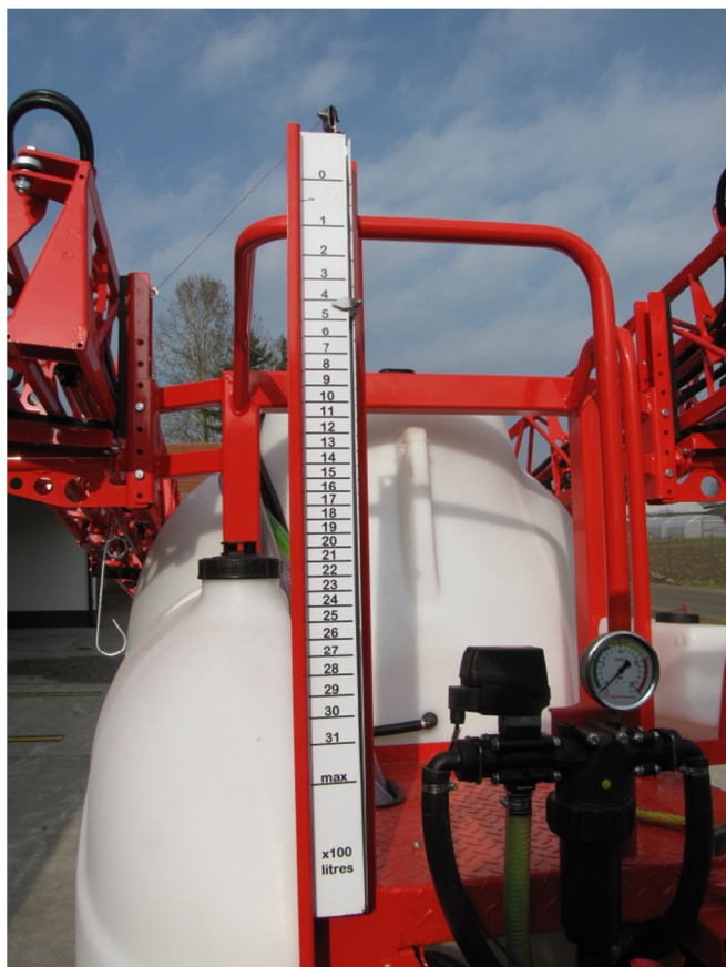
Slika: Prikazovalnik količine škropiva v rezervoarju. Količina škropiva je razvidna tudi na displeju na AG-TRONIC-u.
