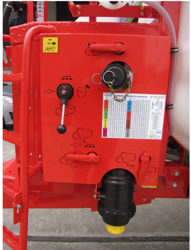
Slika: Sesalni filter je dostopen brez težav. Nad njim je glavni ventil, tropotni sesalni ventil, priklop za polnjenje z vodo, tropotni ventil na povratnem vodu.
