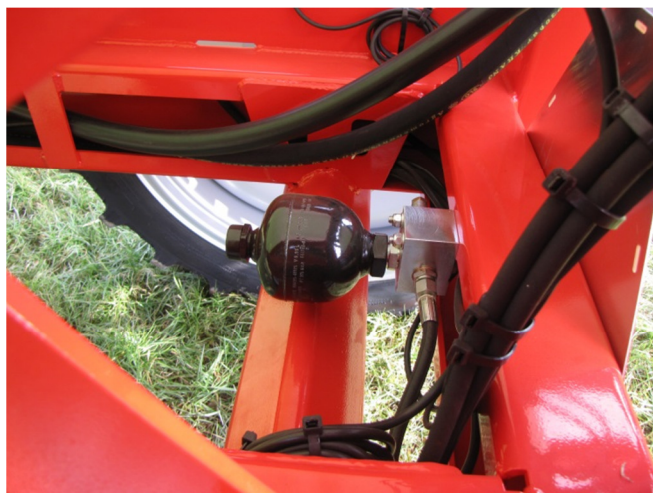
Slika: Hidravlični akumulator napolnjen z dušikom za vertikalno vzmetenje škropilnih letev
