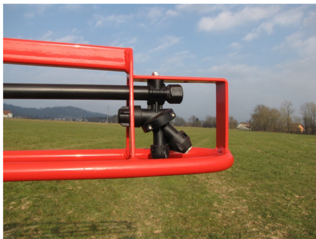
Slika: Nosilec šob TRI-JET s protikapnim membranskim ventilom in tremi različnimi šobami (šobnimi ustniki) so dobro zaščiteni pred poškodbami.
