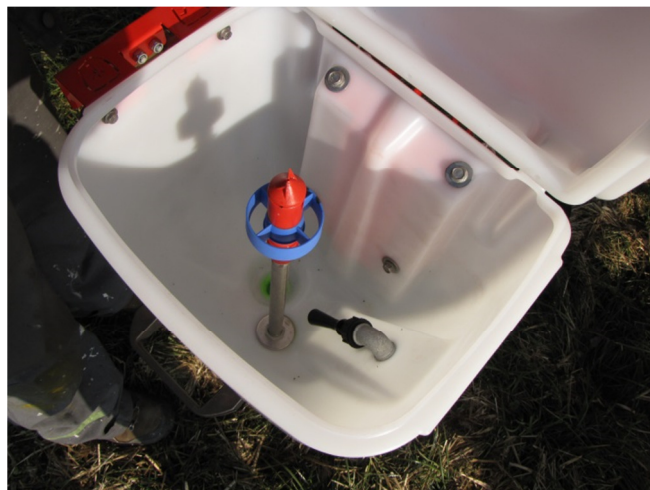
Slika: Polnilna posoda s šobo za mešanje (črna) in šobo za izpiranje embalaže FFS. Ob strani posode sta še dva ventila za upravljanje.
