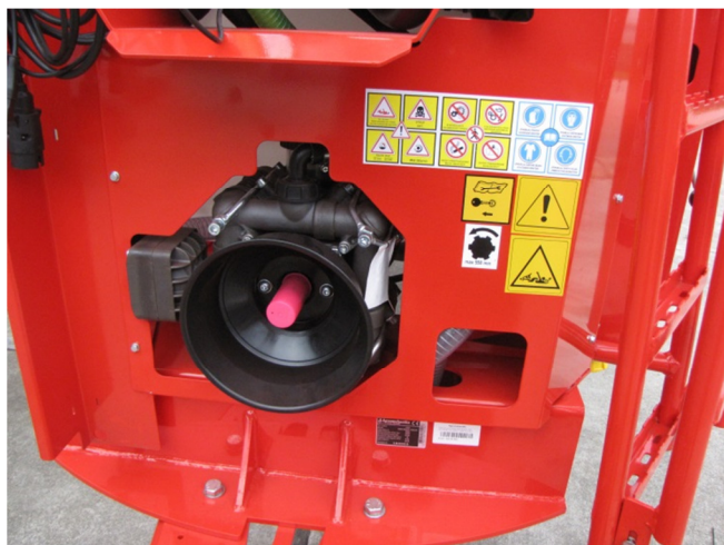
Slika: Preko priključne gredi traktorja gnana batno membranska črpalka BM 150/20. Za zaščitno pločevino je tudi centrifugalna črpalka C 200, ki je gnana preko jermenskega prenosa.
