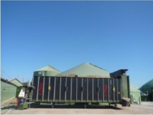
Avtomatski dovajalnik trdnega substrata
