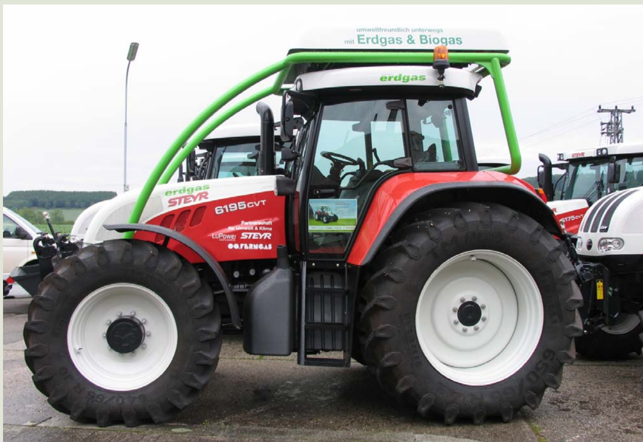
Prva generacija traktorja Steyr, ki deluje na biometan, rezervoarji za biometan so nameščeni na strehi.
