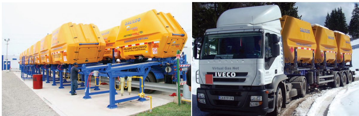
Slika 7: Sistem prevoza stisnjene plina – sistem Galileo “virtualni cevovod”; Vir: Galileo SA
