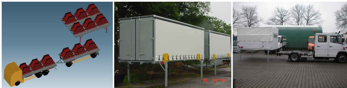
Slika 6: Sistemi prevoza rezervoarjev za stisnjen plin, ki uporabljajo sistem WAB: konstrukcijska študija tovornjaka za prevoz plina s 150 cilindri prostornine 80 litrov pri 220 barih (levo); zamenljiv tovorni prostor (keson) (sredina); lahek kamion z zamenljivim tovornim prostorom (kesonom) (desno); Vir: Güssing Energy Technologies GmbH, Schoon Fahrzeugsysteme
