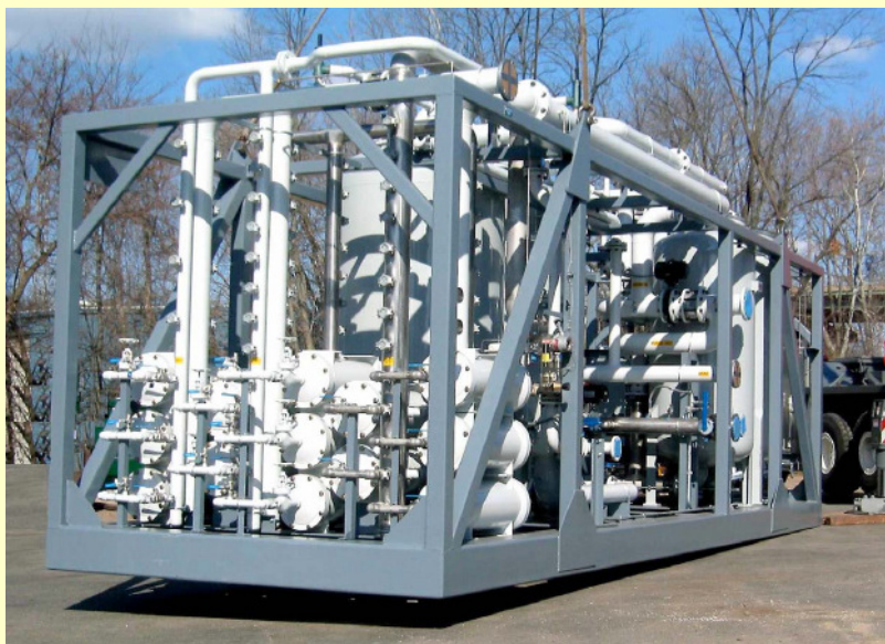
Tehnologija za čiščenje bioplina do faze biometana (Air Liquid)
