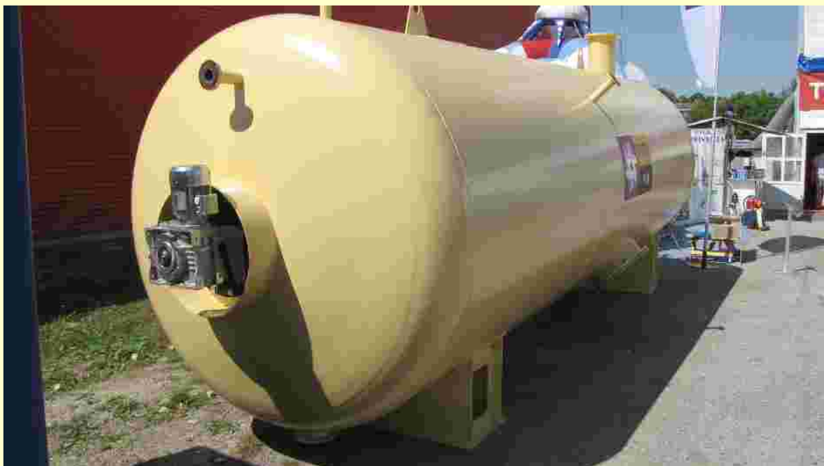
Digestor za povezavo z mikro bioplinsko napravo kontejnerske izvedbe (Omega air, Ljubljana)
