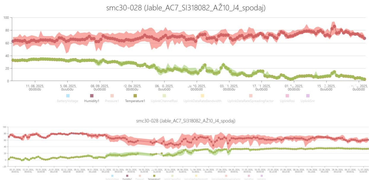
Slika 14. Pod sati AŽ 11+3 v Jabljah, potek temperature (zeleno) in vlage (rdeče) zgoraj v obdobju 1.8.-31.12.2025, in spodaj 1.1.-15.7.2026.
