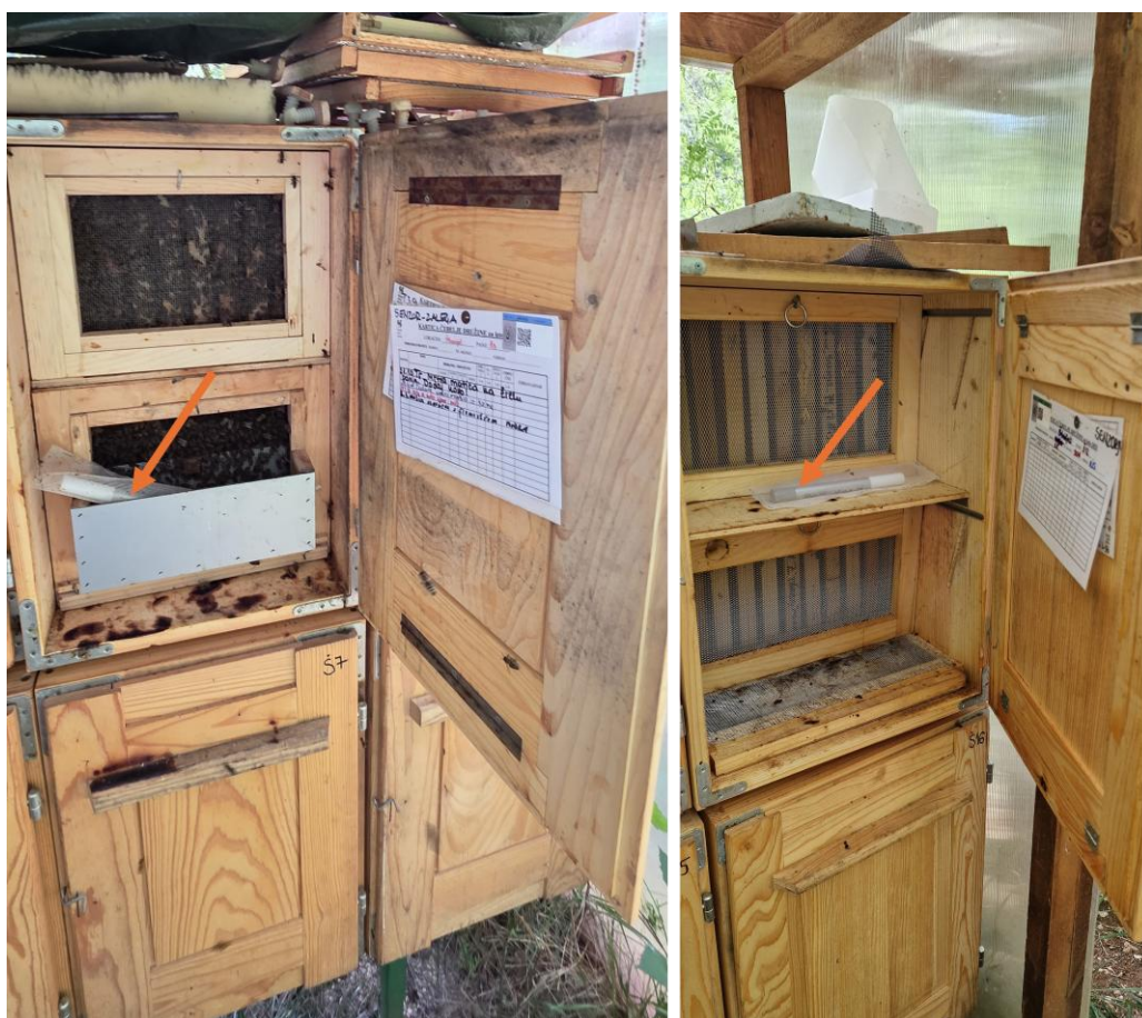
Slika 2. Senzorji so postavljeni v zadnji del AŽ panjev: v AŽ 10 (levo) in AŽ 11+3 (desno).
