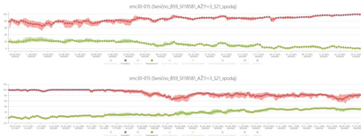
Slika 17. Zalega panja AŽ 11+3 v Seničnem, potek temperature (zeleno) in vlage (rdeče) zgoraj v obdobju 1.8.-31.12.2025, spodaj 1.1.-15.7.2026.
